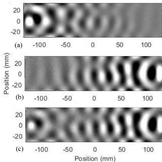
**FIGURE 9:** WAVE PROAPGATION CASES FOR NONLINEAR ANALYSIS: (a) PWAS2 EXCITATION CASE; (b) PWAS1 EXCITATION CASE; (c) PWAS1 + PWAS2 EXCITATION CASE
